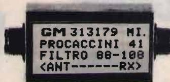
Filtro anti disturbo per ricevitori scanner (attenuatore della banda 88-108) utilizzabile anche in trasmissione per apparati in 2 m.
